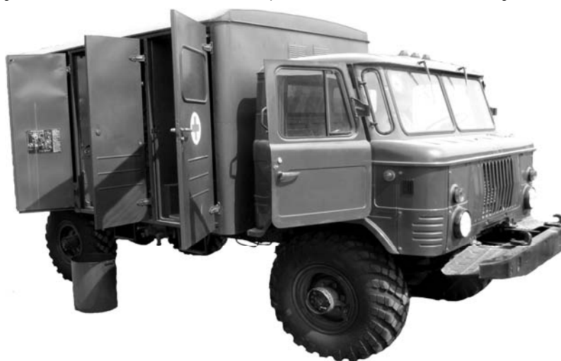
Рисунок 4 — Дезинфекционно-душевая установка на автомобиле ДДА-66
