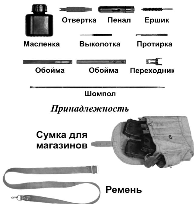
**Рисунок 4 — Составляющие комплекта автомата**
