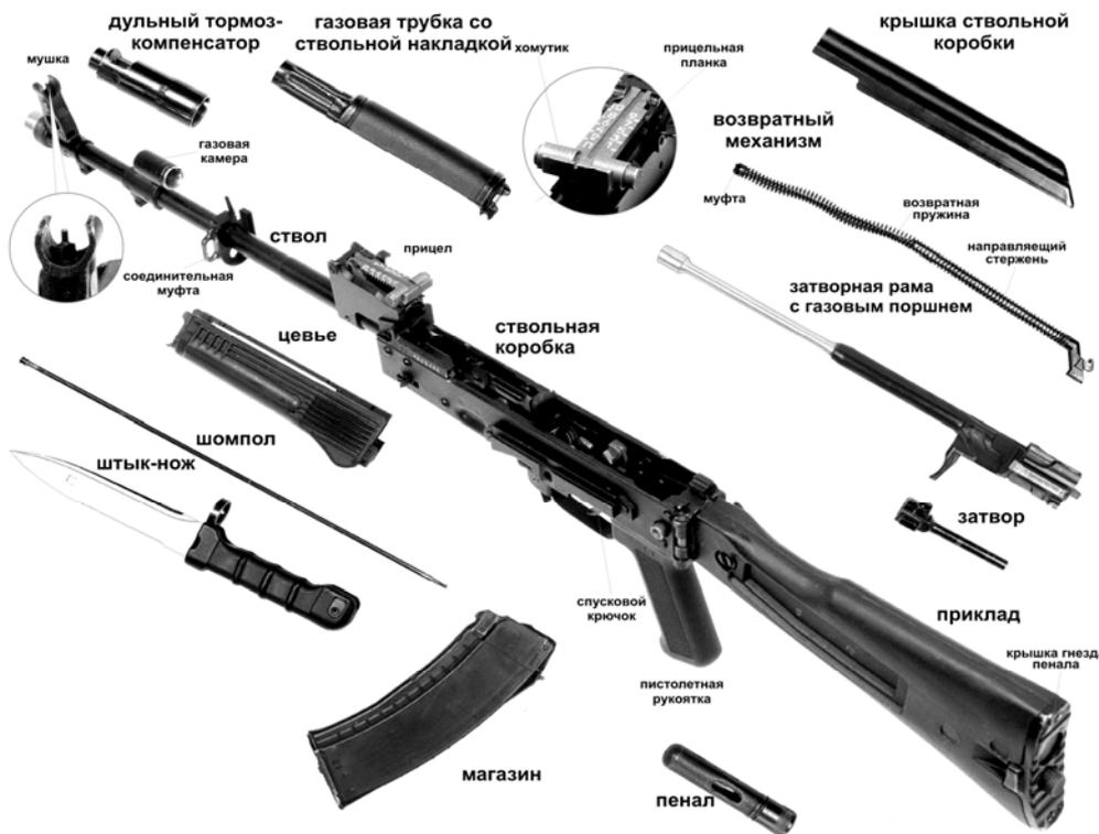
**Рисунок 3 — Основные части и механизмы автомата**
