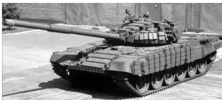
Рисунок 58 — Танк Т-72Б с навесной динамической защитой
