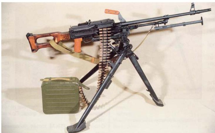
**Рисунок 26 — ПКСМН на станке**
