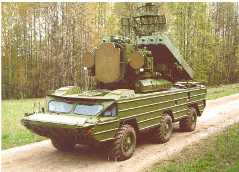
**Рисунок 6 — Самоходная установка ЗРК «Оса»**
