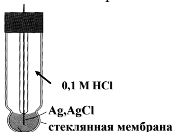
Рисунок 6 — Устройство стеклянного электрода с водородной функцией
