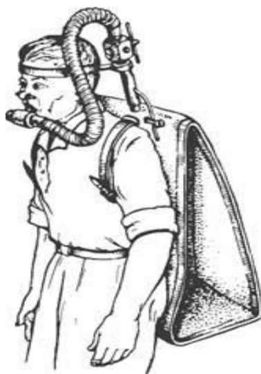
Рисунок 1.3 — Открытая респираторная система (метод Дугласа — Холдейна)
