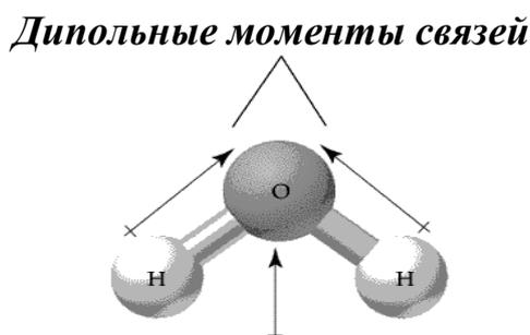
Рисунок 11.15 — Молекула  $\text{H}_2\text{O}$  полярна вследствие нелинейного строения
