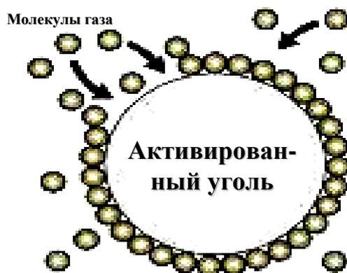
Рисунок 15.3 — Адсорбция газа на поверхности активированного угля
