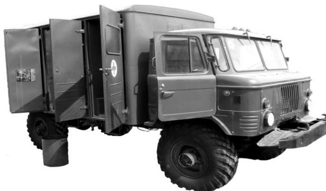
**Рисунок 7 — Дезинфекционно-душевая установка на автомобиле ДДА-66**
