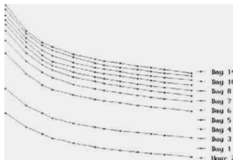
Рисунок 1 - Номограмма для определения коэффициента регистрации детектора в зависимости от массы осадка (мг) и времени накопления вторичного  $^{90}\text{Y}$
