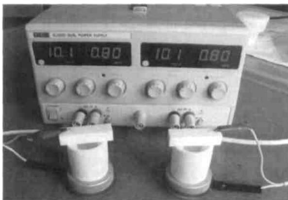
Рисунок 3 - Система для электроосаждения
