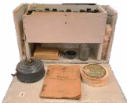
Рисунок 8 – Набор для анализа воды и пищевых продуктов
