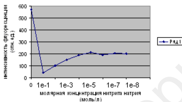
Рисунок 3 — Зондовая флуоресценция БСА в водном растворе
