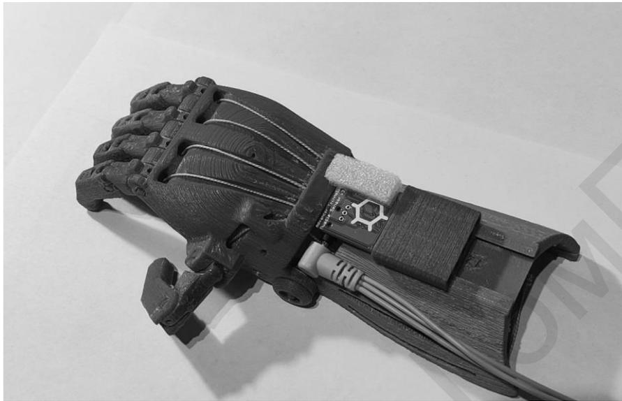
**Рисунок 1 — Прототип механического протеза**
