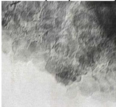
Рисунок 1 — Электронные микрофотографии  $Mg_2Al-LDH$ : диаметр  $D = 40-80$  нм
