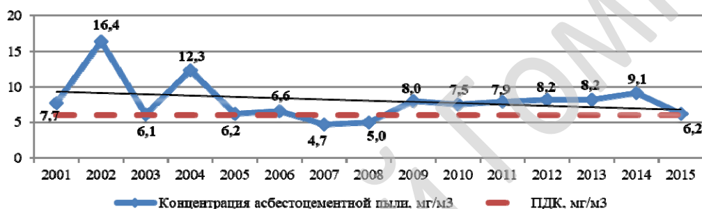
Рисунок 2 — Результаты исследований воздуха рабочей зоны на рабочем месте токаря по обточке асбестоцементных изделий ОАО «Красносельскстройматериалы» за 2001–2015 гг.
