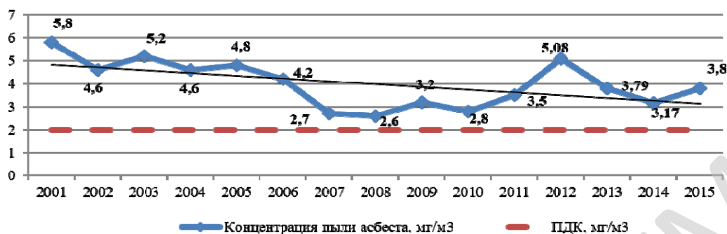
Рисунок 1 — Результаты исследований воздуха рабочей зоны на рабочем месте дозировщика асбеста шиферного цеха ОАО «Красносельскстройматериалы» за 2001–2015 гг.
