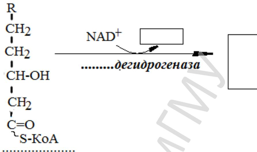
Рисунок 23.12 — Схема реакции β-окисления жирных кислот катализируемая NAD-зависимой дегидрогеназой
