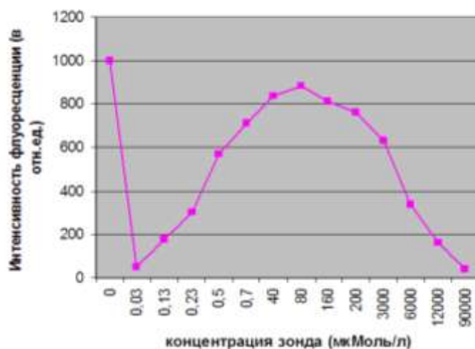
Рисунок 7 — Значения максимумов интенсивности зондовой флуоресценции при титровании БСА зондом АНС
