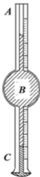
Рисунок 10 — Схема простейшего сталагмометра
