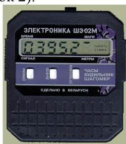
Рисунок 1 — Счетчик шагов электронный «Электроника ШЭ-02М» (НПО «Интеграл»)
