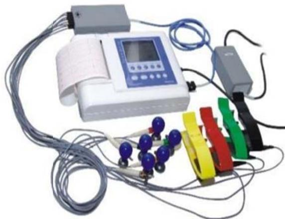
Аппарат ЭКГ состоит из электронного усилителя, способного усиливать сигнал, поступающий с поверхности тела почти в 500 раз (рисунок 7). В аппарате имеется: специальное калибровочное устройство, переключатель — коммутатор отведений, который через специальный кабель подключается к электродам на теле пациента. Плановые исследования проводятся после 10–15 мин отдыха не ранее, чем через 2 ч после приема пищи. Обычное положение — лежа на спине. Дыхание ровное, неглубокое.
