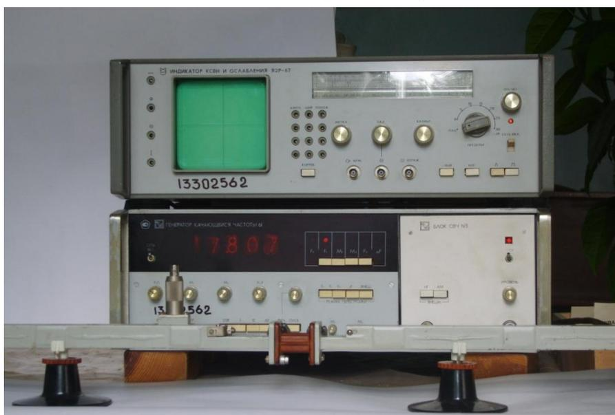
**Рисунок 2 — Измеритель коэффициента стоячей волны и ослабления панорамный**
