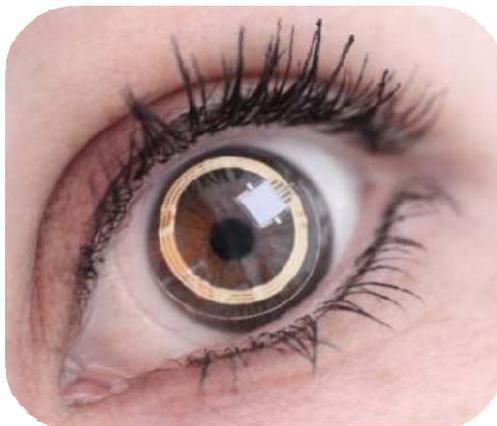
Рисунок 14 — Линза, измеряющая ВГД
