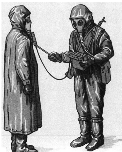
Рисунок 6 — Измерение степени радиоактивного заражения одежды с помощью ДП-5В
