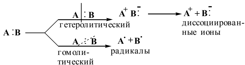
Рисунок 10 — Схема разрыва химических связей
