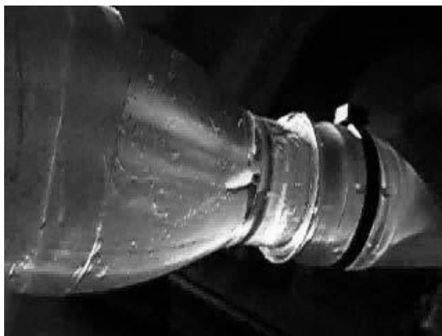
Рис. 9. Визуализация течения в зоне установки оптимизированного ИКС.
