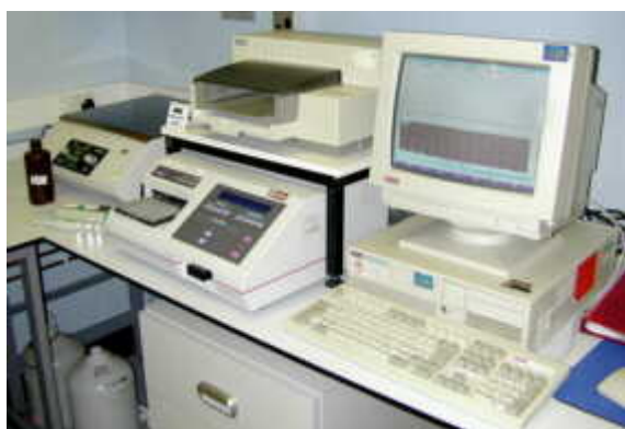
Рис.5. Количество окрашенного продукта измеряется на фотометре при определенной длине волны.
