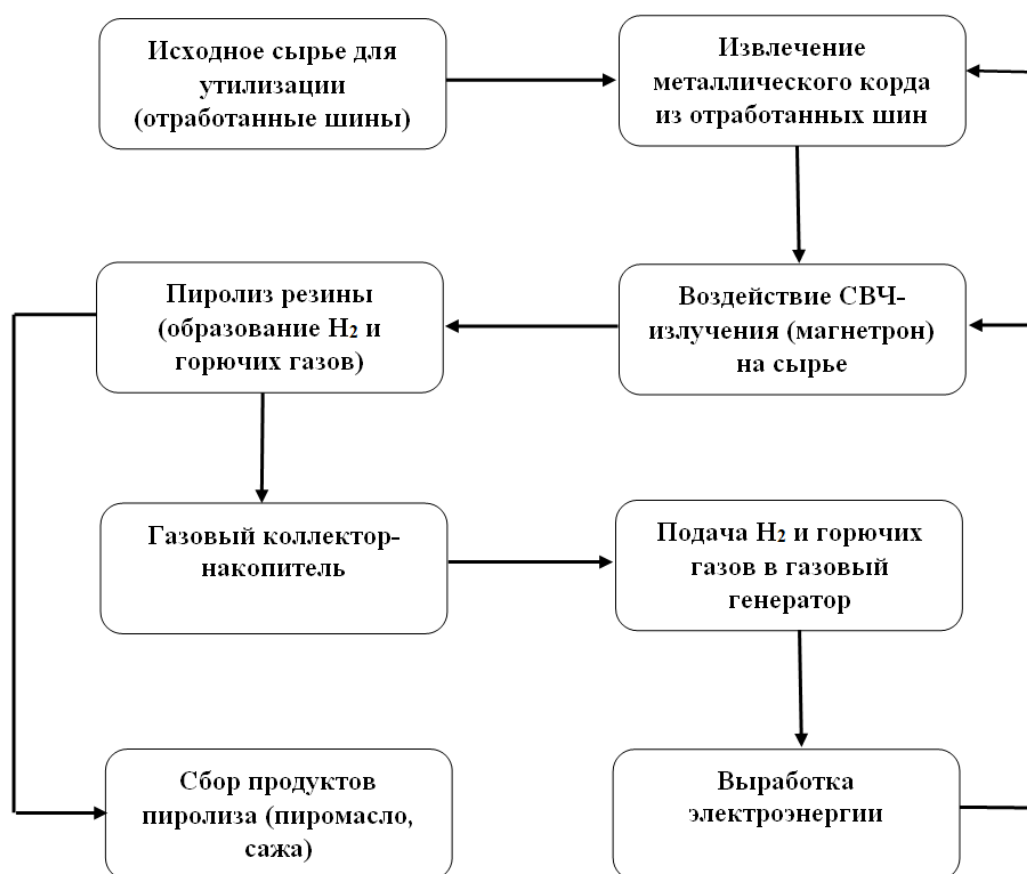
Рисунок 2 – Блок-схема работы СВЧ-установки по утилизации шин
