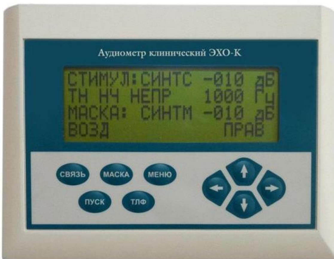
Рисунок 1 – Внешний вид аудиометра ЭХО-К
