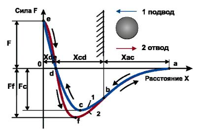
Рисунок 1 — Схематическое изображение зависимости поверхностных сил межмолекулярного взаимодействия двух твердых тел от расстояния между ними: 1, 2 — зависимости при сближении и отводе тел соответственно
