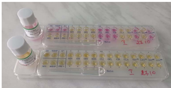
Рисунок 1 — 30-луночные круглодонные полистироловые планшеты с различными антибактериальными препаратами
