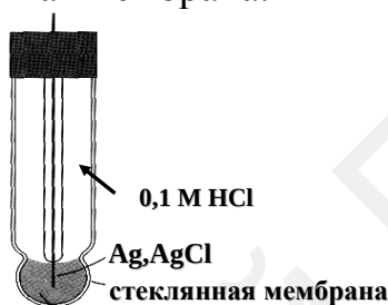
Рисунок 8 — Устройство стеклянного электрода с водородной функцией Схема ГЭ для определения pH
